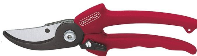
Lama in acciaio al carbonio legato e temperato HRC 54-56 che garantisce resistenza e ottimo taglio - Controlama e portalama brunite in acciaio al carbonio temperato - Impugnatura in materiale plastico - Lunghezza 21 cm. - Peso 230 gr. - Diametro taglio 24 mm.
