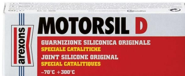
Elastomero monocomponente di tipo acetico. Vulcanizza a temperatura ambiente. Buona resistenza alla temperatura, all'acqua, all'umidità. Ottima resistenza agli oli. Buone proprietà dielettriche. Ottima resistenza allo strappo. Elevato grado di assorbimento delle vibrazioni. Buona resistenza alle sollecitazioni meccaniche. Temperatura di esercizio: da -70°C a +250°C con punte di 300°C. Non danneggia le marmitte catalitiche. Facile da rimuovere.
